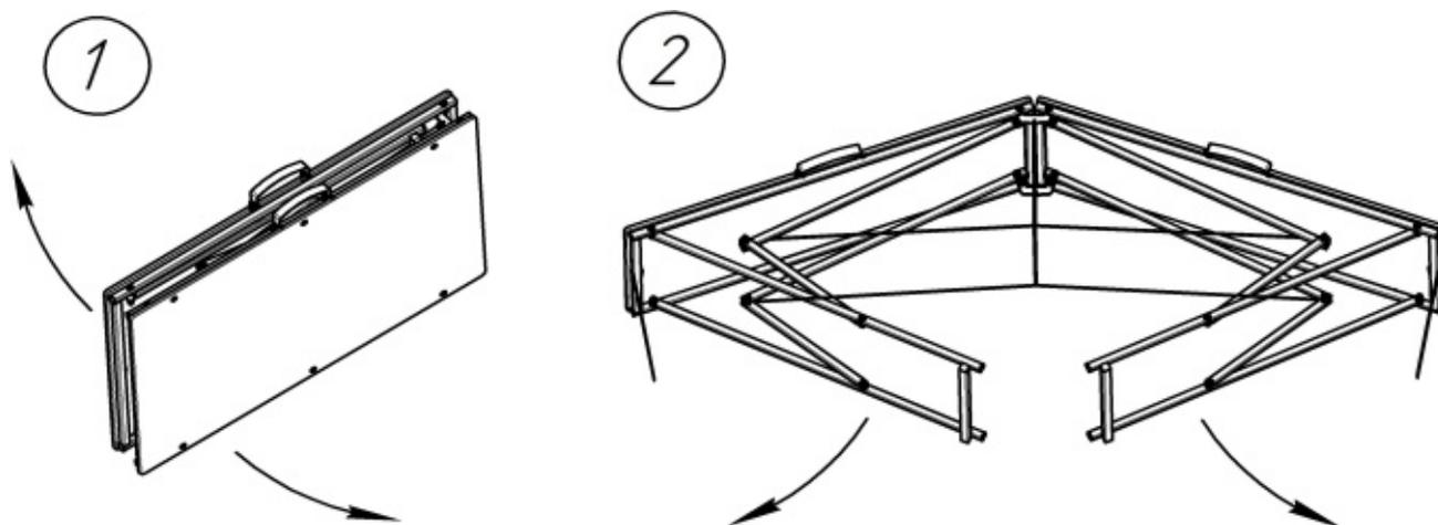
Рис.2 Установка полка в рабочее положение
